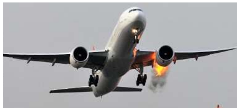
Abb. 8: Boeing B-767 mit ausgefallenem linkem Triebwerk in Landekonfiguration. Durchstartverfahren auf der RWY 01 müssen für dieses Szenario ausgelegt werden.
