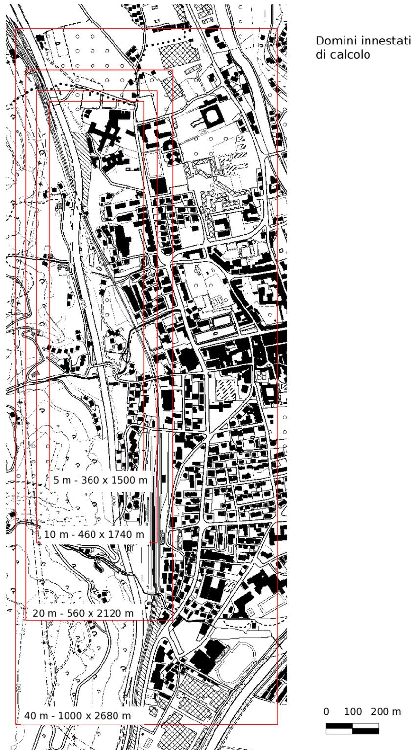
Fig.15 - Domini di calcolo innestati utilizzati nelle simulazioni con AUSTAL2000.
